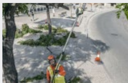
Der Akku-Hochentaster 536LiPT5 verfügt über einen Teleskopschaft mit einer Reichweite von bis zu 5,5 m.
